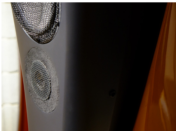
旋轉高音單體旁邊的小螺絲，即可調整高音單體的前後位置，調整幅度為3.5mm。
